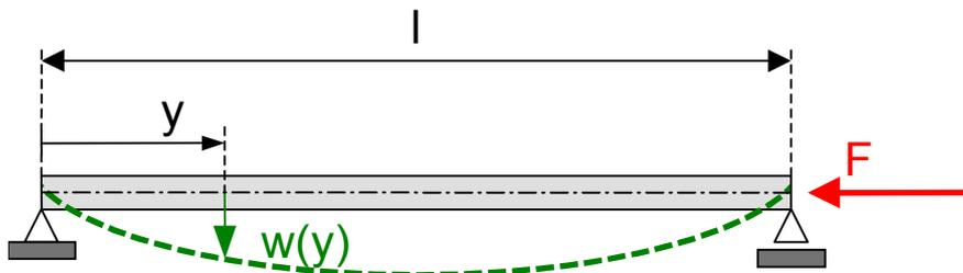
$$-\frac{d^2w}{dy^2} = \frac{M(y)}{E \cdot I} \quad \text{Differentialgleichung der Biegelinie}$$
